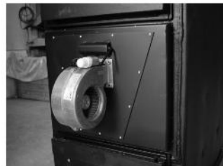
Klapka ventilátoru (8) s odnímatelnou přední stěnou (po demontáži přední stěny možnost čištění rozvodových kanálů primárního a sekundárního vzduchu)
