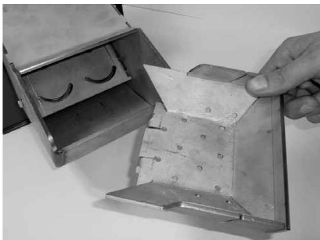
Obr. 1 - vyjímatelná spalovací komůrka - nutno pravidelně čistit
