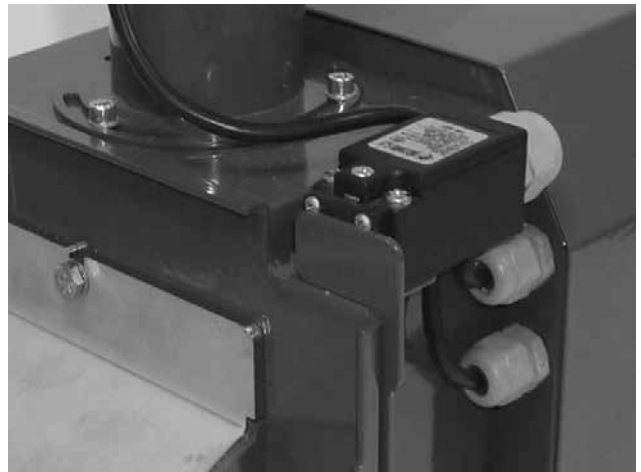
Obr. 8 - koncový spínač se speciálním dorazem
